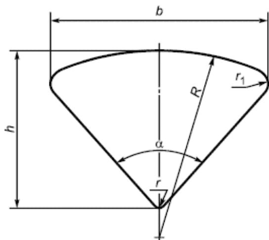
$r \geq 0,5$  мм - радиус закругления
