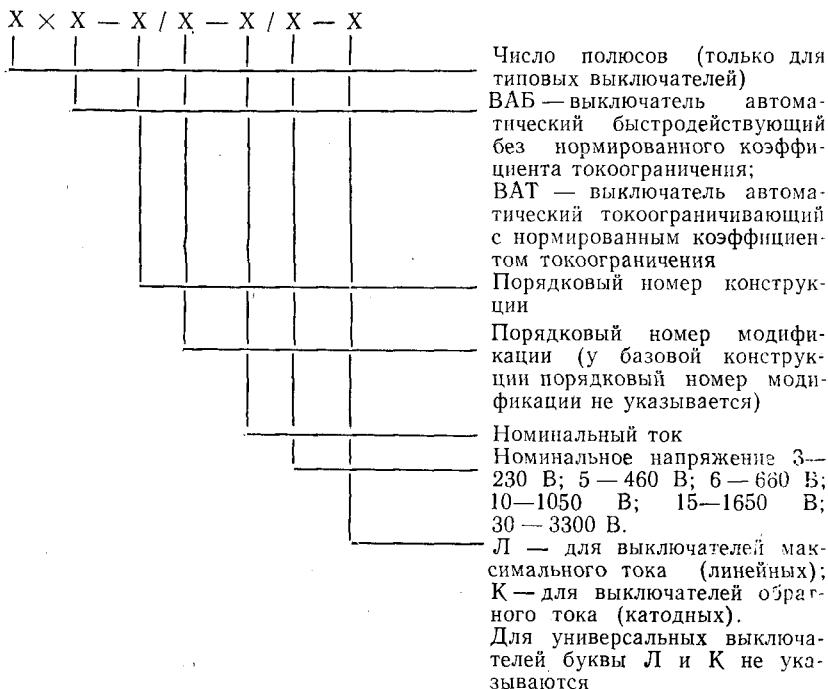
Пример условного обозначения выключателя автоматического быстродействующего, порядкового номера конструкции 43, на номинальный ток 4000 А, номинальное напряжение до 3300 В, максимального тока:
