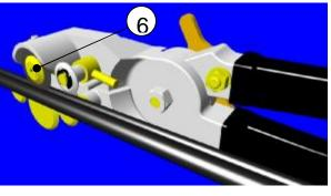
При помощи рычажка 3 поместите ролики 7 в соприкосновение с перемычкой кабеля, затем затяните рифленую гайку 2 .
