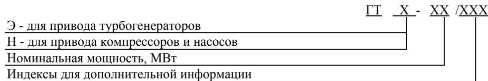
Примечание. Индексы для дополнительной информации изготовитель может использовать для обеспечения модификации газотурбинной установки.
