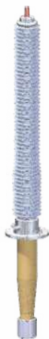
Вводы «воздух — масло» для силовых трансформаторов и шунтирующих реакторов Напряжение: 12–1200 кВ Ток: 315–5000 А Изоляция: RIP или RIN (до 550 кВ)
