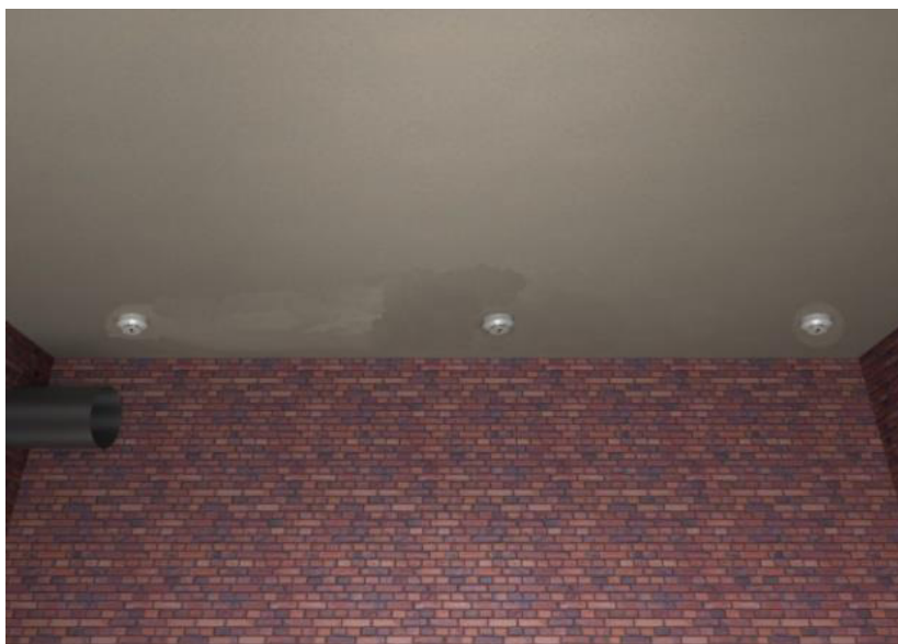
Рисунок 25. Неправильное размещение пожарных извещателей
