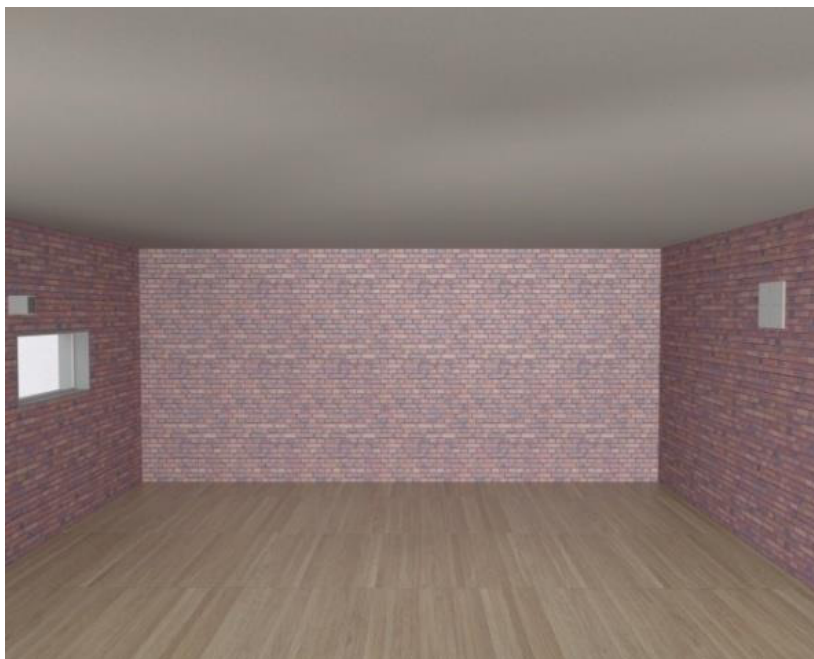
Рисунок 20. Слишком низкое размещение линейного дымового пожарного извещателя
