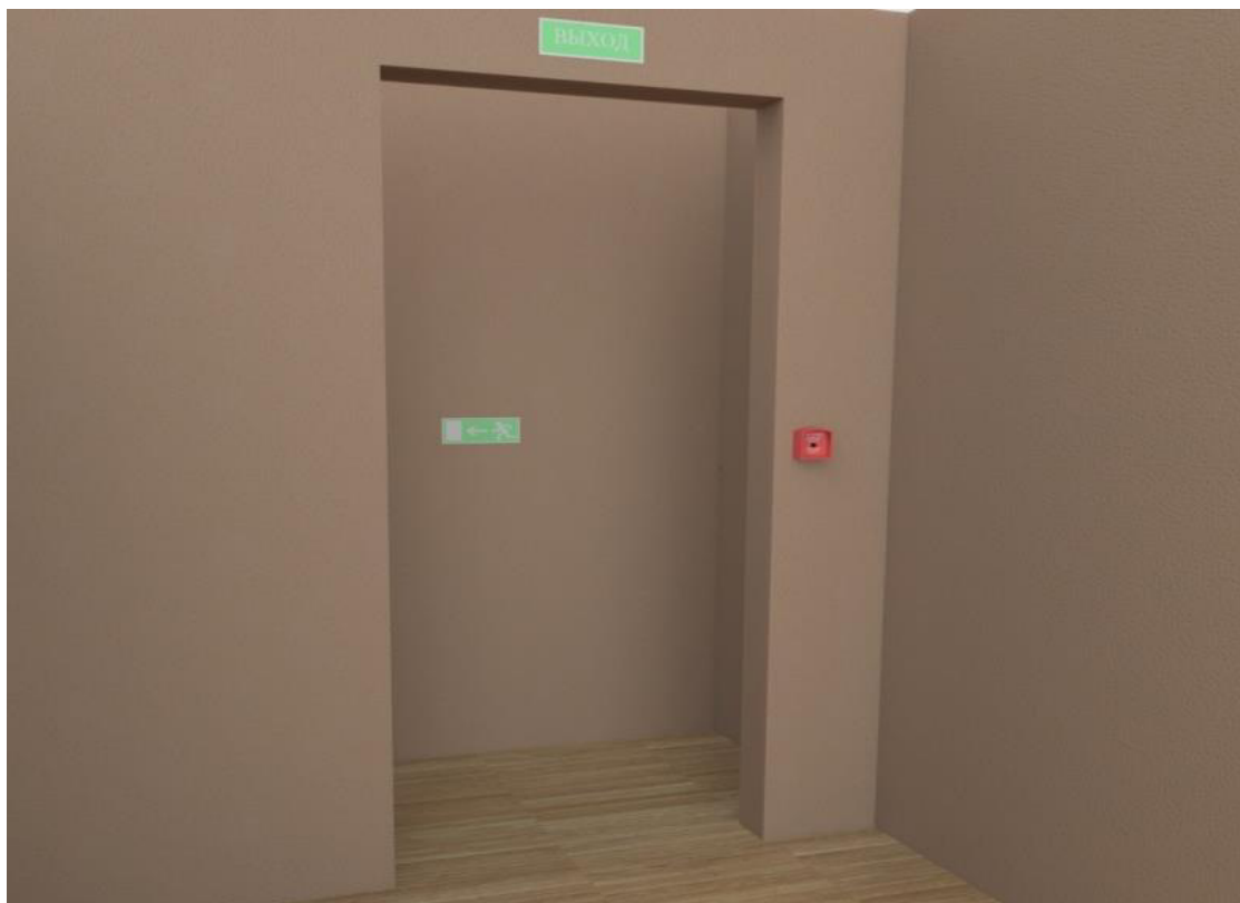
Рисунок 39. Высота размещения указателя менее 2 м.
