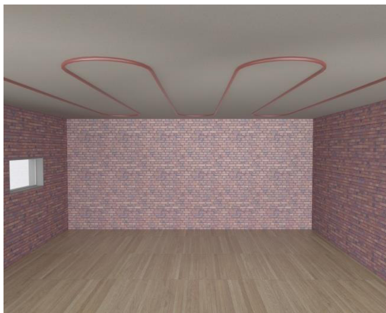
Рисунок 27. Неправильный монтаж линейно теплового извещателя
