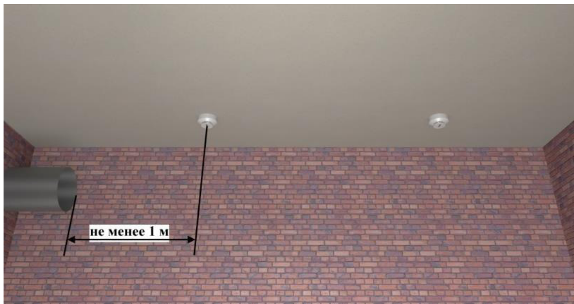
Рисунок 4. СП 484.1311500.2020 к п. 6.6.32 Расстояние от точечного ИП до вентиляционного отверстия должно быть не менее 1 м. Извещатель может быть установлен на более близком расстоянии от вентиляционного отверстия вытяжной вентиляции, если расчетная скорость воздушного потока в месте установки извещателя не превышает 1,0 м/с. При расчетных скоростях воздушного потока вытяжной вентиляции более 1,0 м/с ИП следует устанавливать на расстоянии более 1 м от вентиляционного отверстия или внутри вентиляционного канала с помощью специализированных монтажных комплектов (только для дымовых извещателей) или снаружи вентиляционного канала при помощи специальных приспособлений, монтируемых непосредственно на вентиляционном канале и забирающих пробы из потока удаляемого воздуха, при этом монтаж следует осуществлять в соответствии с рекомендациями, изложенными в ТД изготовителя данного монтажного комплекта.
