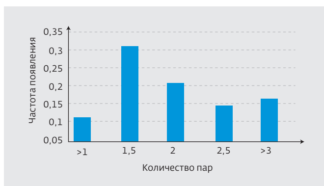
Рис.4. Гистограмма количества пар магистрального кабеля на одну типовую 2-портовую пользовательскую информационную розетку СКС (среднее значение 2,1)
