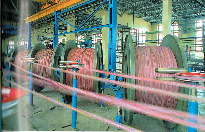
Цех №4. Линия фирмы «Pourtier» для скрутки сердечника телефонных кабелей емкостью до 1200 пар из 50 или 100 парных пучков до и после модернизации.
