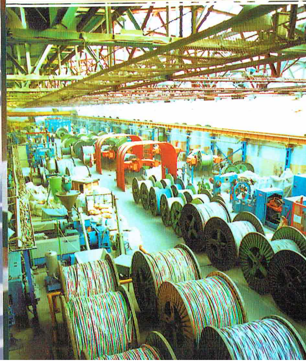
Цех №5. Линия фирмы «NOKIA-MAILEFER» для производства кабелей с заполнением .
