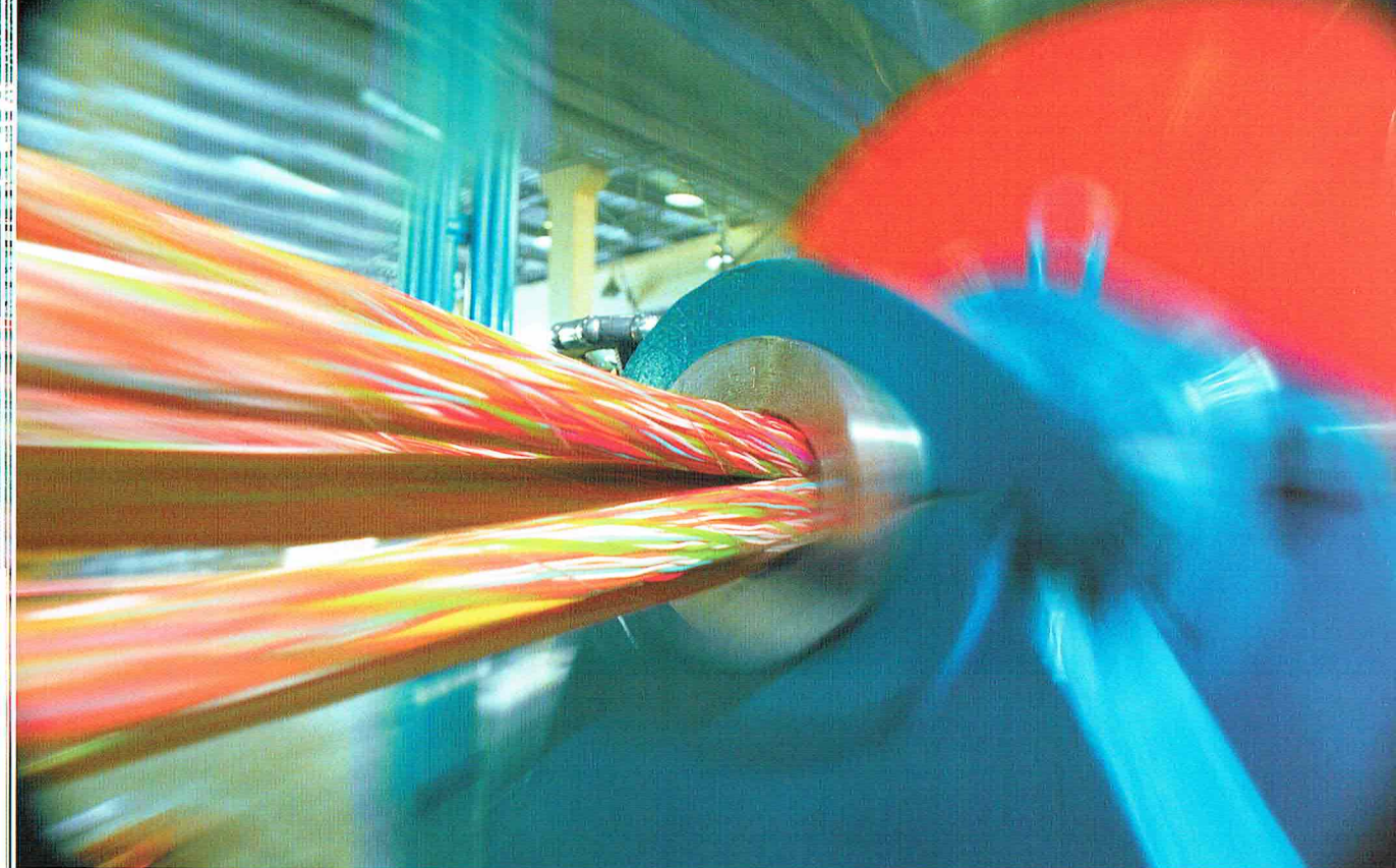
Цех №4. Линия фирмы «Pourtier» для скрутки сердечника телефонных кабелей емкостью до 1200 пар из 50 или 100 парных пучков до и после модернизации.
