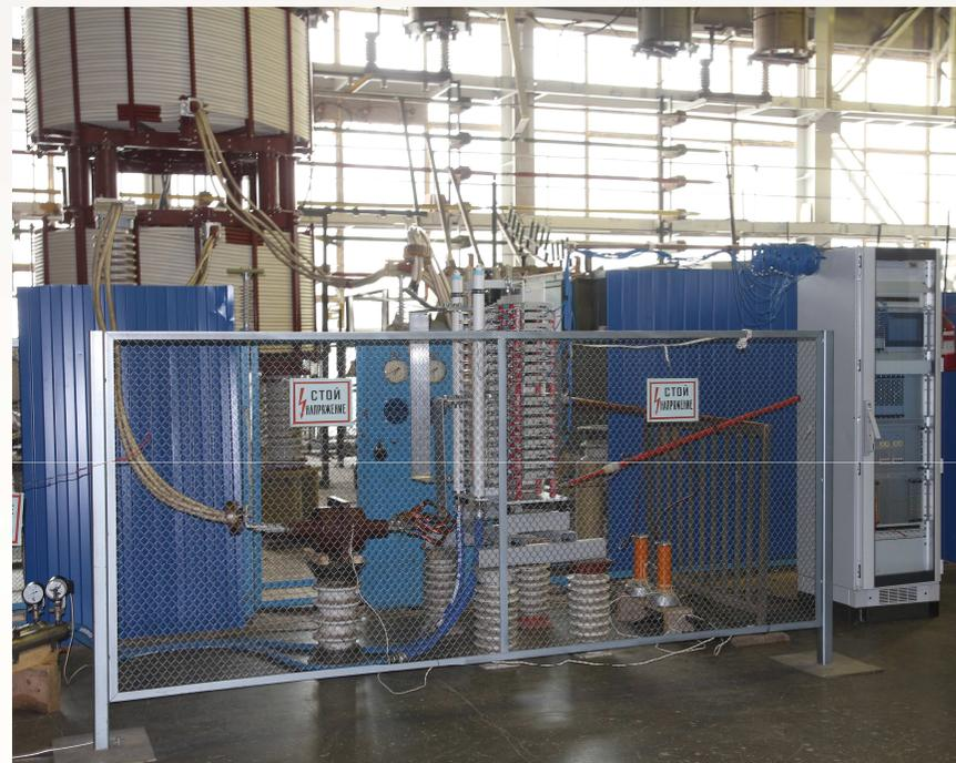
Создан комплекс оборудования, позволяющий передавать 50 МВт мощности по кабельным линиям постоянного тока, в том числе с использованием явления высокотемпературной сверхпроводимости.
