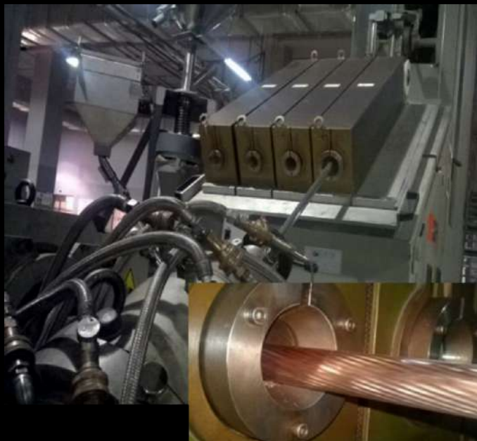
РИС. 2 : ПРЕДВАРИТЕЛЬНЫЙ НАГРЕВ ПРОВОДНИКОВ В ПРОИЗВОДСТВЕННОЙ ЛИНИИ (СТОЙКА С 4 ИНДУКТОРАМИ)
