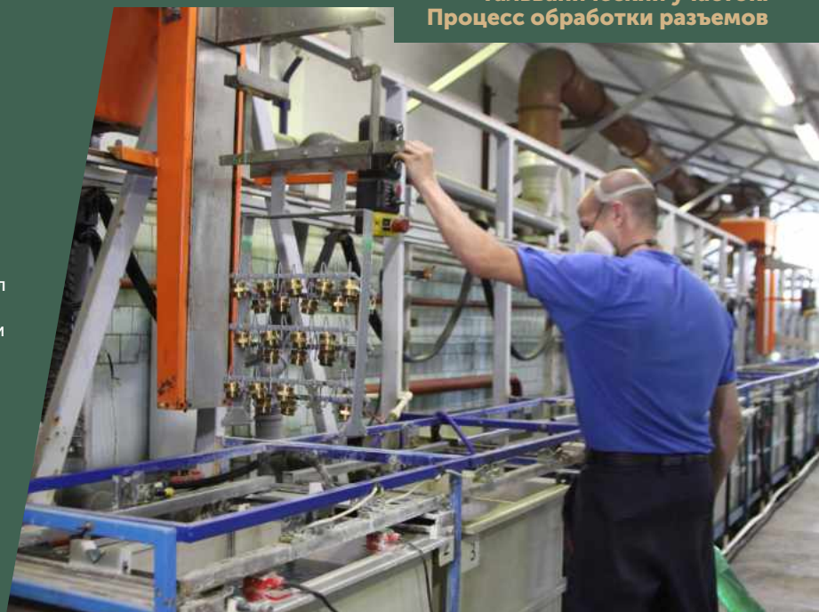
Гальванический участок. Процесс обработки разъемов
