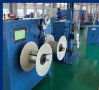
YL –ЛИНИЯ БУХТОВАНИЯ 8-ОБРАЗНОГО ТИПА
