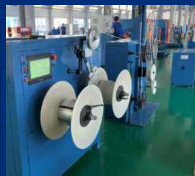
YL –ЛИНИЯ БУХТОВАНИЯ 8-ОБРАЗНОГО ТИПА
