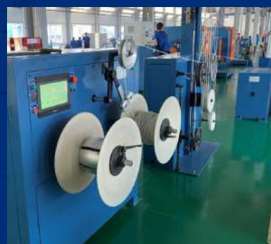
YL –ЛИНИЯ БУХТОВАНИЯ 8-ОБРАЗНОГО ТИПА
