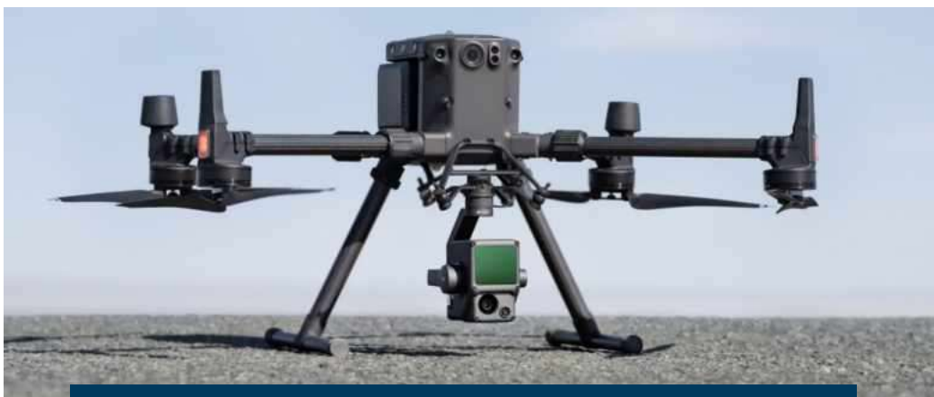
Беспилотный комплекс для воздушного лазерного сканирования на основе Matrice 300 RTK + Zenmuse L1
