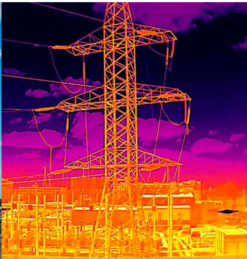
Тепловизионная съемка ЛЭП с помощью комплекса Matrice 300 RTK и полезной нагрузки H20N
