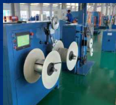
YL –ЛИНИЯ БУХТОВАНИЯ 8-ОБРАЗНОГО ТИПА
