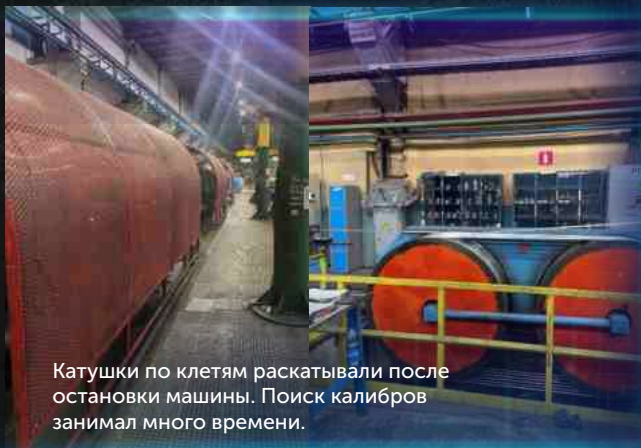
Катушки оператор раскатывает по клетям во время работы оборудования. Шкаф с роликами и калибрами был перенесен ближе к машине. Все ролики и калибры перебрали и поставили в подписанные ячейки.
