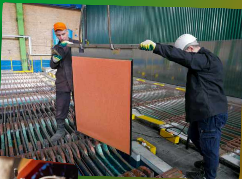
Получение собственных катодов в электролизном цехе Кабельного Завода «ЭКСПЕРТ-КАБЕЛЬ»
