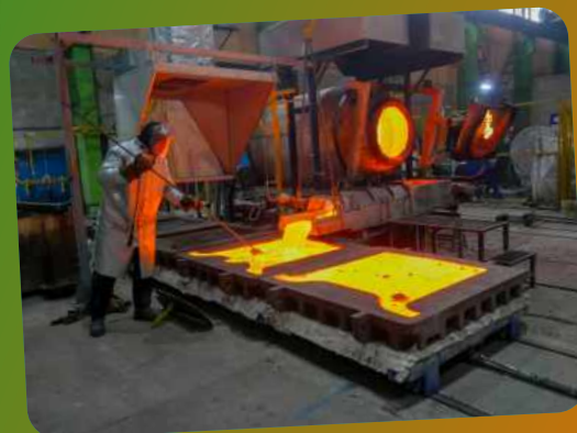
Получение собственных катодов в электролизном цехе Кабельного Завода «ЭКСПЕРТ-КАБЕЛЬ»
