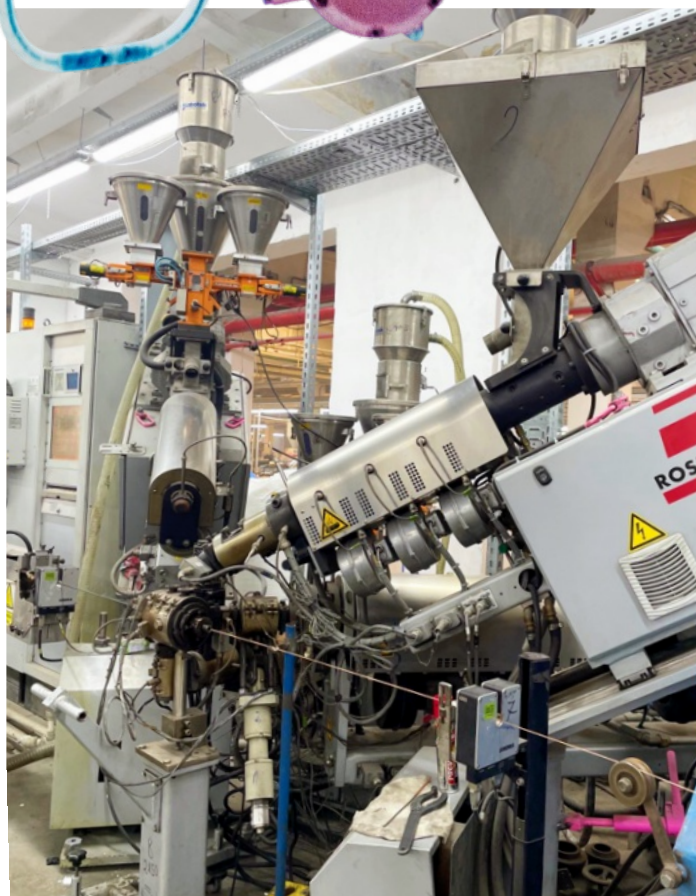
Рис. 4. ПВХ гранулы и оборудование для наложения изоляции или оболочки на кабель
