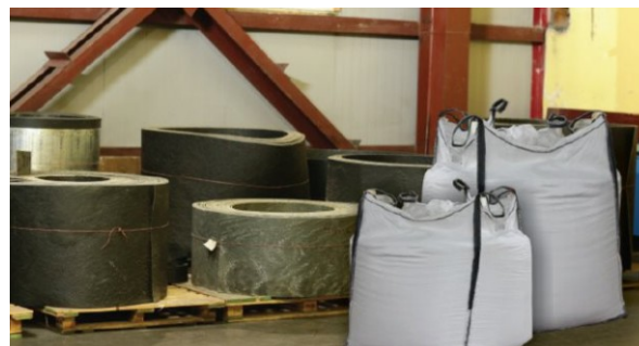
Полимерные маты «Томсккабель» поставляются в рулонах на паллетах или в мешках «биг-бэг» из полипропиленовой или капроновой (полиамидной) ткани.
