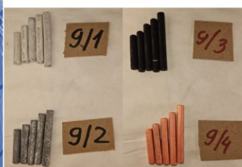
Рис. 4. Образцы после выдержки в течение 126 суток в 1%-м растворе \text{Ca}(\text{OH})_2 : 9/1 — из алюминиевого сплава без промывки, 9/2 — из алюминиевого сплава с промывкой, 9/3 — из меди без промывки, 9/4 — из меди с промывкой
