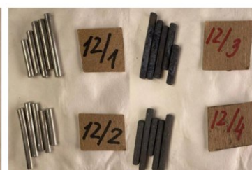
Рис. 5. Образцы после выдержки в течение 126 суток в газовой среде сероводорода ( \text{H}_2\text{S} ): 12/1 — из алюминиевого сплава без промывки, 12/2 — из алюминиевого сплава с промывкой, 12/3 — из меди без промывки, 12/4 — из меди с промывкой
