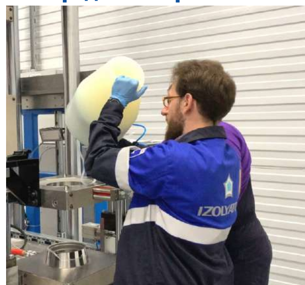
Уже готовый стресс-конус муфты извлекают из пресс-формы
